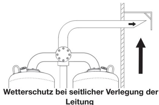
**Wetterschutz bei seitlicher Verlegung der Leitung**
